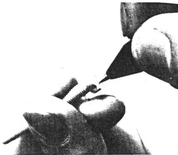
Midiendo el espesor de películas de depósitos electrolíticos
